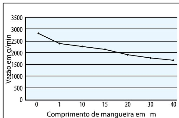
O a. m. Os valores de desempenho são baseados nas seguintes condições de teste: graxa de lítio NLGI 0 a 22 ° C - Pressão de ar comprimido 8 bar - saída de fluxo livre 1/2"
