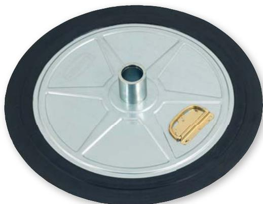
Placa seguidora com borda de borracha, para aplicações com bombas de graxa pneumática da série "Power Bull" em 180 kg - bateria. A placa do seguidor provoca um nível de graxa constante dentro do tambor e ajuda a evitar quaisquer bolsas de ar dentro da graxa perto do tubo de sucção, bem como quaisquer eliminações de graxa na superfície interna do tambor. Diâmetro total da placa seguidora 590 mm, diâmetro do disco metálico 540 mm, diâmetro do furo para tubo de aspiração 50 mm.
