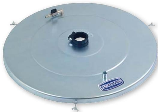
Tampa de tambor de metal, incluindo adaptador de fecho de metal e contra-anel de metal, adequado para o uso de bombas de graxa pneumática da série "Power Bull" em 180 kg - bateria. Diâmetro total 600 mm, diâmetro do furo para tubo de sucção no adaptador de folga de 50 mm.
