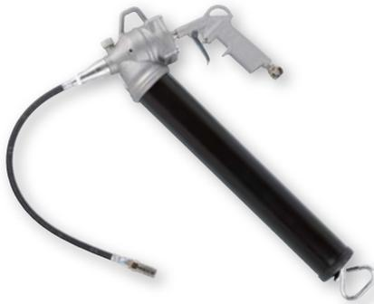
Bomba neumática de engrase manual, tipo pistola para cartuchos ó grasa a granel, equipada con tubo flexible de 300 mm. y boquilla de engrase. El funcionamiento de la pistola es de simple efecto, al accionar la palanca de control, el pistón avanza y empuja la grasa, soltando la palanca, el pistón vuelve a la posición inicial. Repitiendo esta operación podremos realizar el suministro de grasa.
