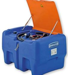
Depósito de polietileno de alta densidad para el transporte de urea (AdBlue® / AUS32) con tapa de cierre hermético, especial para transportar en vehículos furgonetas y pick-up, con tapón de llenado, válvula de seguridad, kit compuesto por bomba eléctrica de suministro de 12 Vcc caudal 25 l/min., 4 m de manguera con pistola automática de suministro y cable de 4 m con pinzas de conexión a batería, su base especialmente diseñada nos permite su transporte con carretilla elevadora.
