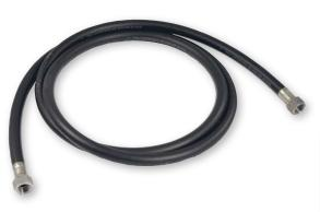
Manguera de goma sintética modelo GPH con conexiones H \*\*\* (TL) rosca BSP de acero inox, resistentes a la UREA (Adblue®), AGUA a altas y bajas temperaturas, PRODUCTOS QUIMICOS, ACIDOS GLICOL, AIRE COMPRIMIDO (a baja presión, etc. Fabricada en goma negra reforzada con inserciones de fibras sinteticas de alta resistencia, resistente a la abrasión, calor y agentes atmosféricos. Según normativa BS 2050:1978.
