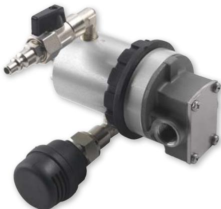
Bomba neumática auto-aspirante, rotativa de engranajes para el trasvase de fluidos y líquidos químicos. Cuerpo de la bomba de acero inoxidable AISI 304, eje en acero inoxidable, engranajes de bronce (bajo demanda de nylon 12, o fibra de vidrio) y empaquetaduras/juntas de VITON®.
