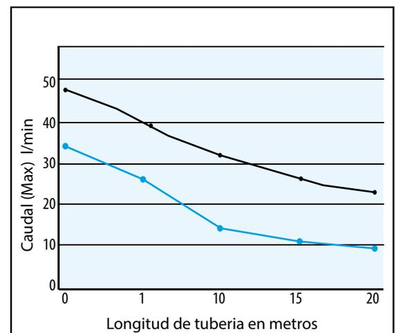
Los valores indicados en la tabla se basan en los siguientes parámetros: Aceite hidráulico Viscosidad ISO 68 a 22°C - presión de aire comprimido 8 bar - salida libre
