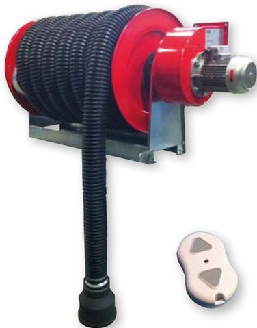
Enrollador de acero pintado con recogida automática por motor eléctrico y turbina de aspiración, ESPECIAL PARA EXTRACCION GASES DE ESCAPE, POLVO, ETC. equipados con mangueras flexibles anti aplastamiento con refuerzo interior de distintos diámetros y longitudes, freno o tope de la manguera y boca de aspiración con tapa de diafragma.
