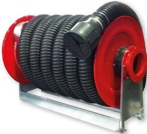
Enrollador automático de acero pintado ESPECIAL PARA EXTRACCION GASES DE ESCAPE, equipados con mangueras flexibles anti aplastamiento con refuerzo interior de distintos diámetros y longitudes, freno o tope de la manguera y boca de aspiración con tapa de diafragma.
