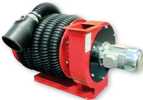
Enrollador automático de acero pintado con turbina de aspiración con motor eléctrico, ESPECIAL PARA EXTRACCION GASES DE ESCAPE, equipados con mangueras flexibles anti aplastamiento con refuerzo interior de distintos diámetros y longitudes, freno o tope de la manguera y boca de aspiración con tapa de diafragma.
