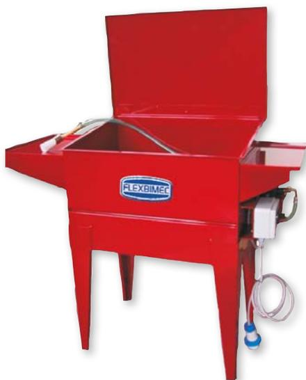
Limpador de peças em aço pintado, com circuito fechado de fluido detergente, constituído por bacia de limpeza com 4 patas e tampa fechável e removível, mangueira com chuveiro, escova de limpeza permeável a fluidos que permite um fluxo contínuo do detergente e uma limpeza precisa de partes. O sistema permite uma circulação contínua de fluido a uma pressão de 0,5 bar pela utilização de uma bomba de imersão elétrica.
