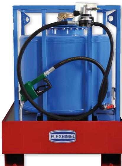
Deposito para almacenaje de gasolina de acero pintado, estructura metálica para protección externa, con boca superior grande  $\varnothing$  300 mm., tapa de seguridad de 10 mm. válvula de seguridad de 2" de diámetro. Equipada con bomba rotativa neumática, regulador de presión de aire, tubo de suministro de 3/4" de 3 m. de longitud y pistola automática de suministro.
