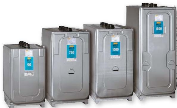
Tanque de parede dupla, tanque externo em aço galvanizado e tanque interno em polietileno de alta densidade, adequado para o armazenamento de óleo residual. Inclui 4 conexões em 2" na parte superior do tanque, indicador de nível mecânico, detector de vazamento ótico para eventuais vazamentos no tanque interno, alças de transporte e pés de paletes para o levantamento e transporte com paleteira ou empilhadeira de 4 lados. Aprovado para instalações internas.
