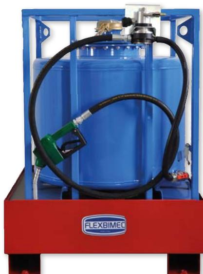
Tanque de armazenamento a gasolina em aço pintado, montado em gaiola de proteção de arame, com pallet de contenção de derramamento, cúpula hermeticamente selada de ø 300 mm com tampa painel e contraflange de 10 mm de espessura de parede, tubo refl e 2" - válvula de segurança.
