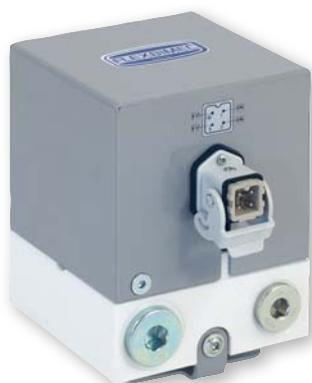
Contador electrónico H 1/2" BSP de engranajes ovales con emisor de impulsos, cuerpo de aluminio con electro-válvula, filtro de cartucho de 150 µm y soporte de fijación, para uso con fluidos de bases acuosas, anticongelante y urea (AdBlue®).
