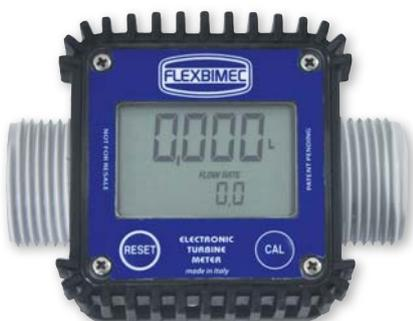
Contador electrónico de turbina, cuerpo de poliamida, con turbina de polipropileno, pantalla Display LCD con 2 lecturas caudal y total (de 0,1 a 999,9). La pantalla display puede girar en 4 posiciones.
