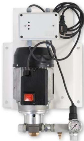
El cuerpo de la bomba y el eje son de acero inoxidable y los engranajes de latón, Incluye interruptor, electro-válvula presostato con un amplio rango de regulación graduada a 10 bar, manómetro, válvula anti-retorno.
