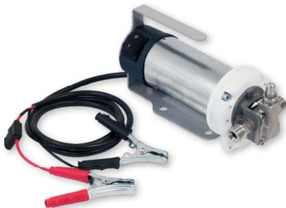
El cuerpo de la bomba y el eje son de acero inoxidable y los engranajes de latón, con válvula by-pass, interruptor on/off y cable de alimentación de 1,5 m. con pinzas para la conexión a batería.
