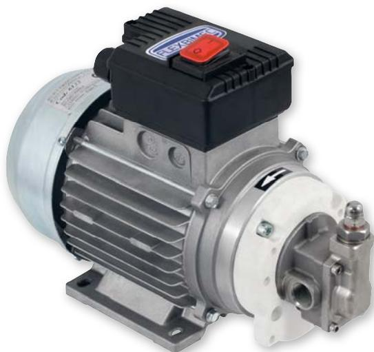
El cuerpo de la bomba y el eje son de acero inoxidable y los engranajes de latón, con válvula by-pass graduada a 10 bar.
